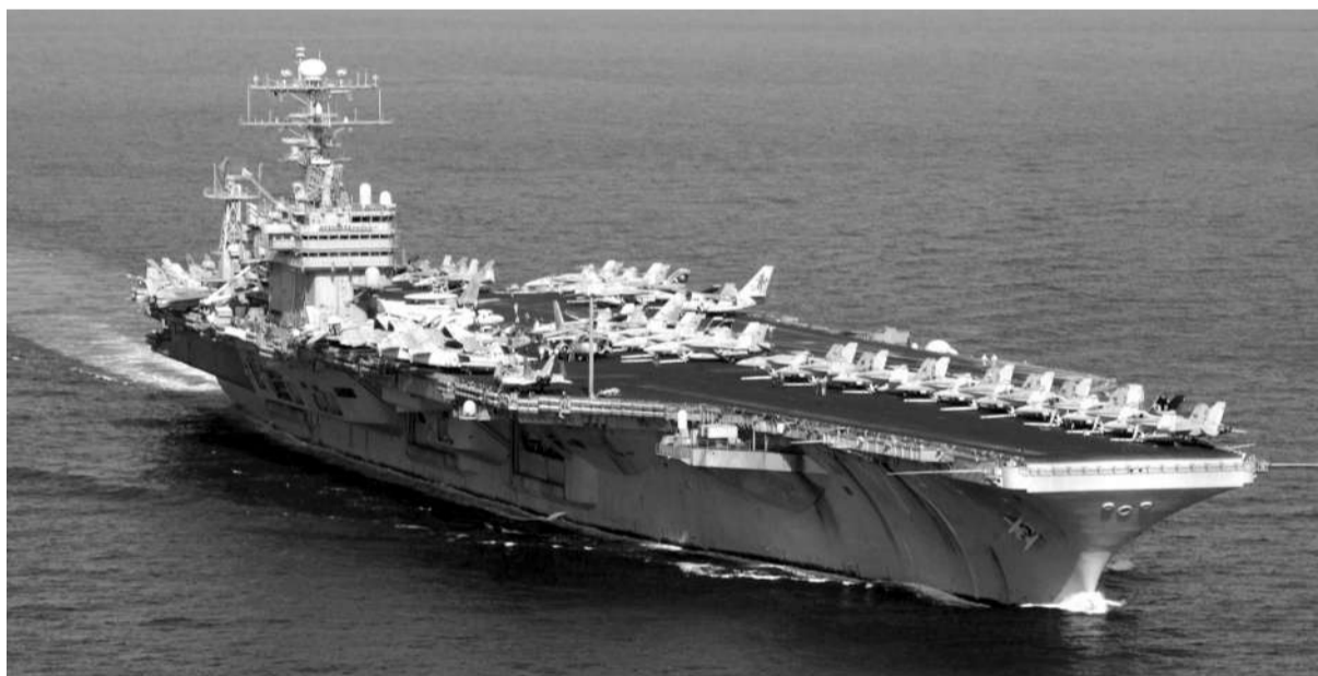
林肯号航母 满载排水量:104000吨 全长:333米 全宽:76.8米 最高速度:30节以上 乘员:约5700人 舰载机:90架 动力装置:2座核反应堆
