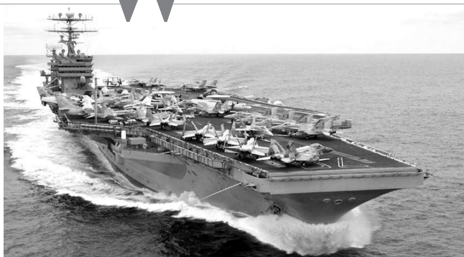
卡尔·文森号航母 排水量:满载91487吨 飞行甲板:长335.6米,宽77.1米 最大航速:30节 舰载机:约80架 载员:约6000人 动力装置:核反应堆
