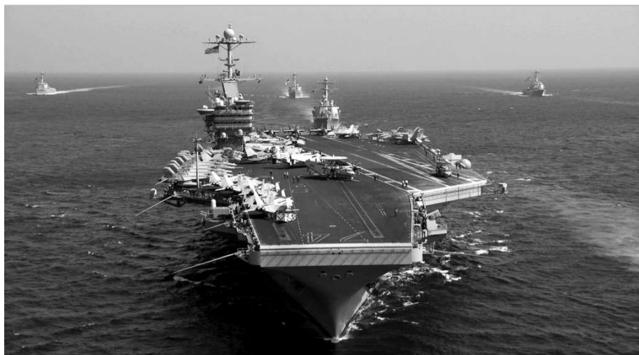
斯坦尼斯号航母 满载排水量:104000吨 全长:333米 全宽:76.8米 舰载机:90架 最高速度:30节以上 乘员:约5700人 动力装置:2座核反应堆
