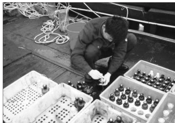
监测人员在现场监测海水盐度、pH值、溶解氧等参数。
