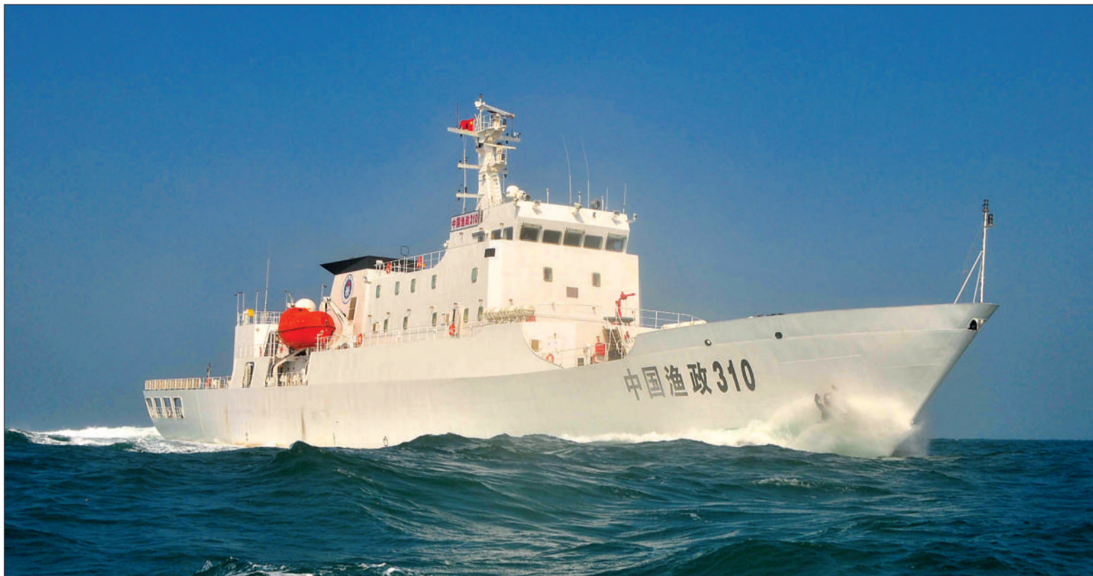
中国渔政310船总吨位2580吨,长108米,宽14米,续航力6000海里,持航60个昼夜,可驶往国际无限航区,最大航速可达每小时22海里。
