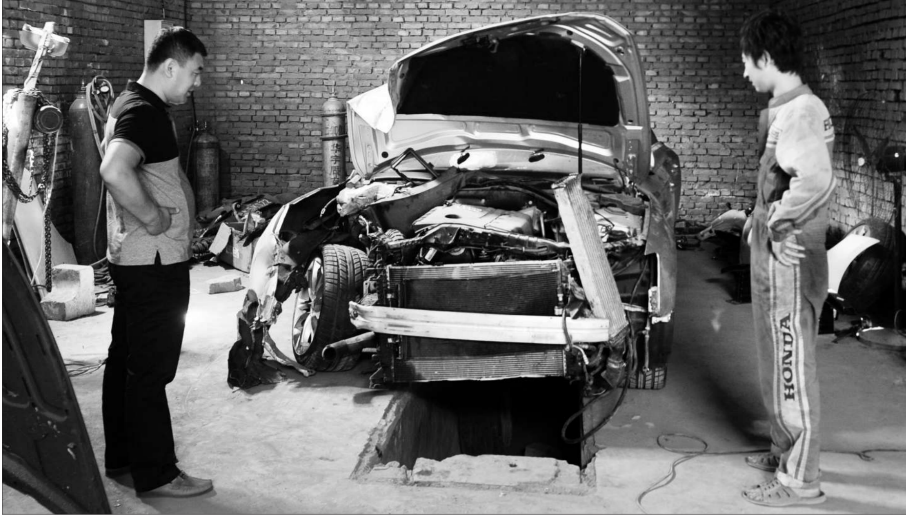
5月10日,18万拍得的奥迪车停在修理厂,工人检测出车头、车身、车尾由三段不同型号的车拼焊而成。
