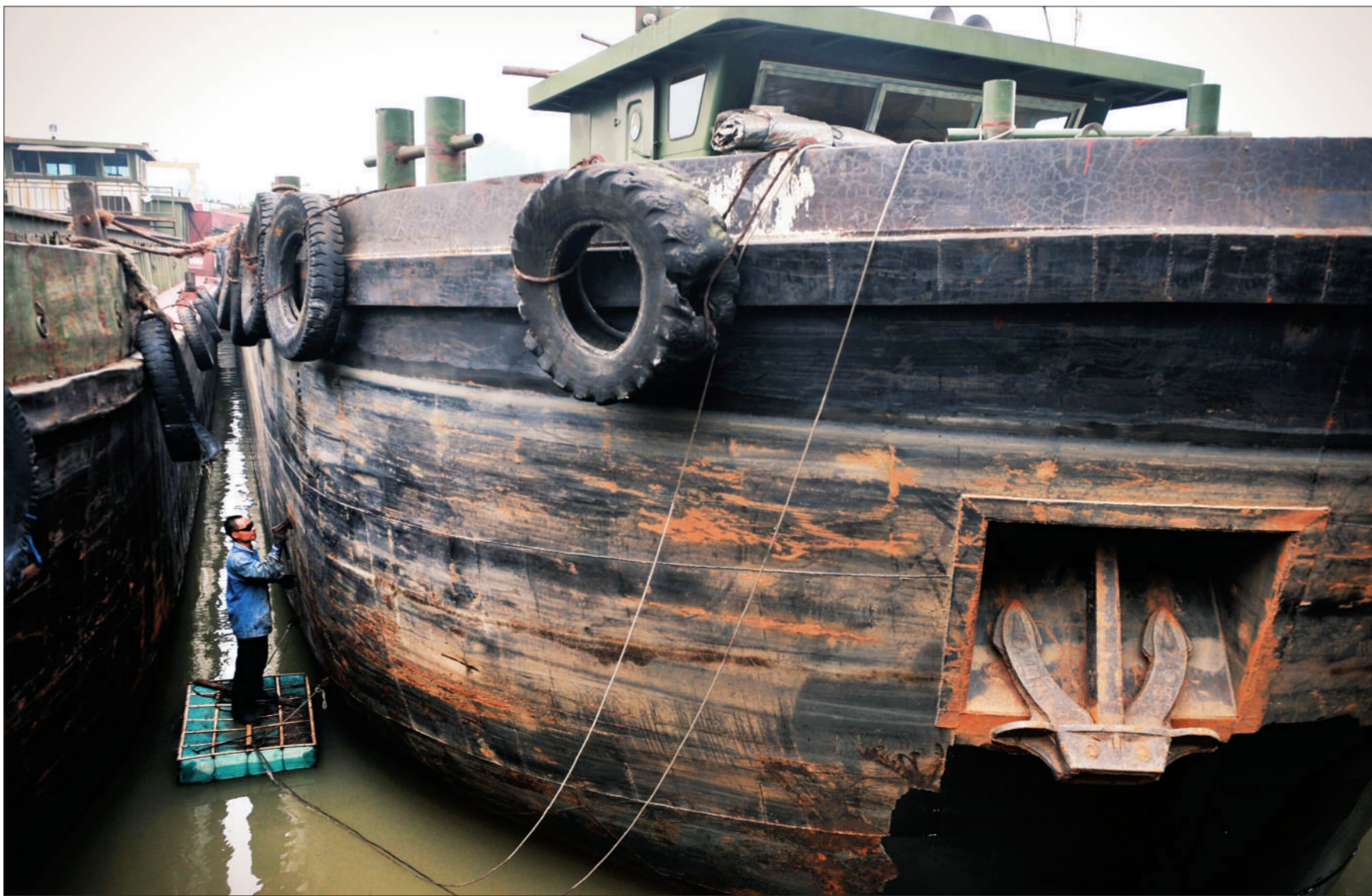
谏壁船闸停靠区,两条船的间隙中,来自徐州的船户站在浮漂上为船体刷漆、除锈。他们守护这一重要的谋生工具一如守护自己的王国。
