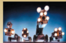
探测下水道的摄像机
