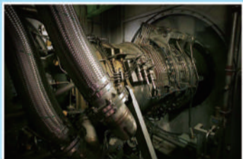
如需要,用飞机引擎改造的抽水泵可将蓄水排入附近的河中。
