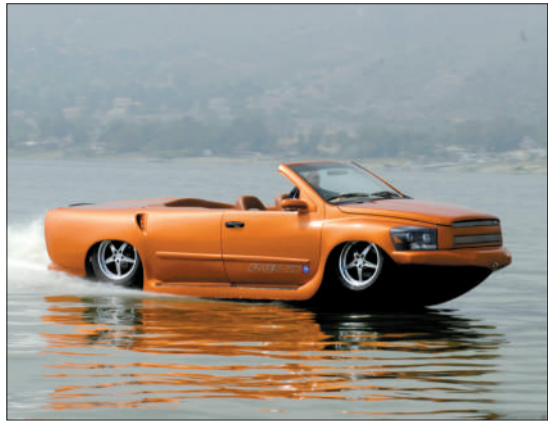
名为 Python 的手工打造水陆两栖车,水中时速可达60英里/小时。 图/CFP
