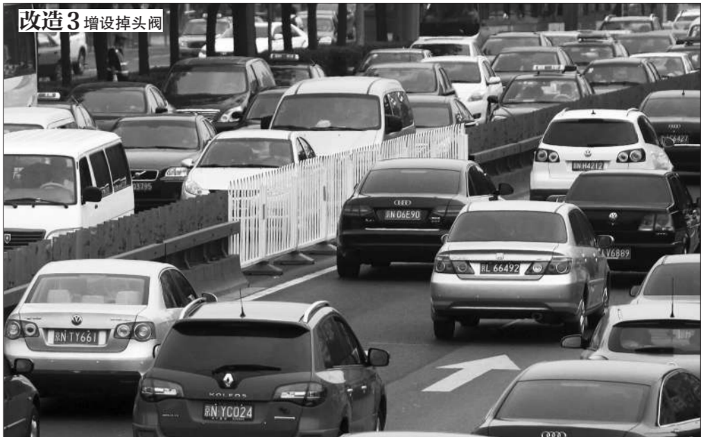
8月7日,复兴门桥下,一组白色掉头闸(可移动隔离带)安装在二环主路上,如果遇到暴雨积水天气,可以挪动隔离带让车辆掉头。新京报记者 薛珺 摄
