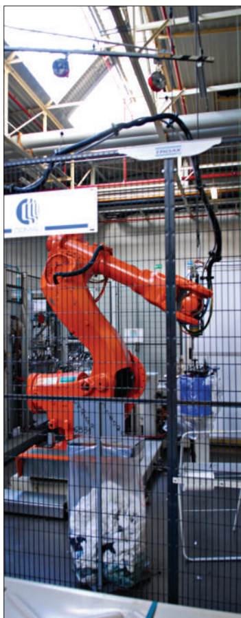
组装缸盖的机器人,每一个托盘上都有个记忆芯片,机器人根据不同发动机型号取件组装。
