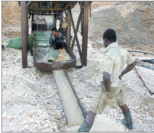
4 清溜 清洗槽槽,将一天冲洗过后的金沙收集。
