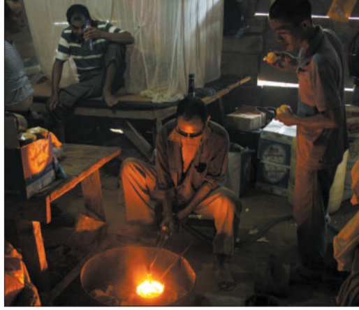
10 熔金 高温将金沙熔化成液态,再铸成金块。
