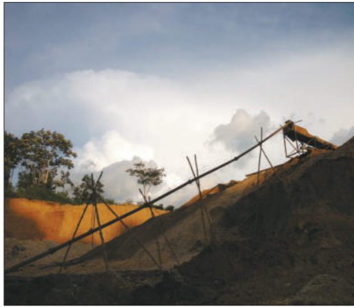
3 砂泵 将混着金沙的水抽上矿井,经过槽槽收金。
