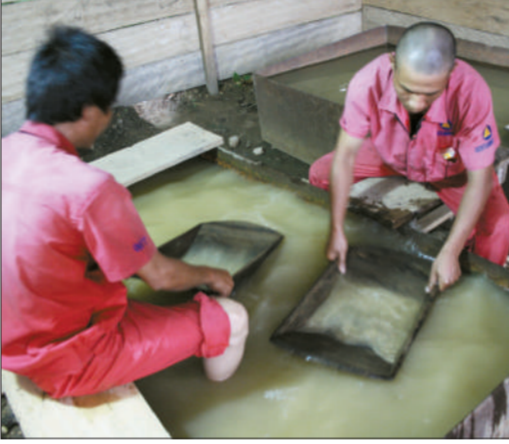
7 淘金 用洗盆洗金子,将金沙冲走,留下砂金。
